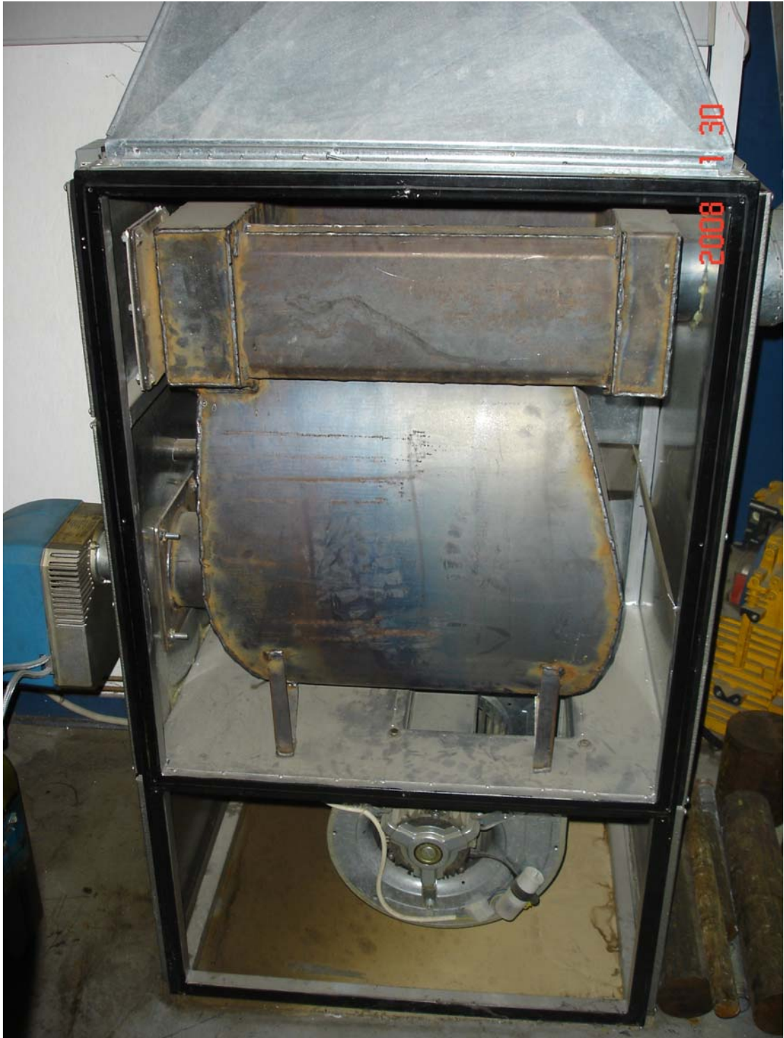
Εικόνα 2 Ο αερολέβητας 35,000 kcal/h (με αφαίρεση του πρόσθιου καλύμματος του εναλλάκτη και της σχάρας εισόδου του ανεμιστήρα)
