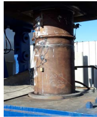
τελικό στάδιο παραμόρφωσης, το κύμα έχει «διπλώσει»
