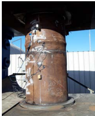
πρώτο στάδιο παραμόρφωσης, δημιουργία αρχικού κύματος λυγισμού
